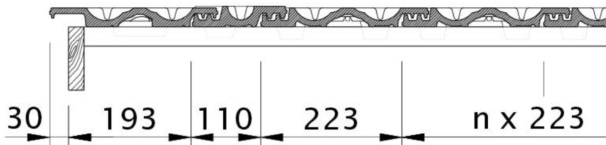
Disegno RATIO gronda di frontespizio sinistra con lamiera laterale e doppia onda OD L
