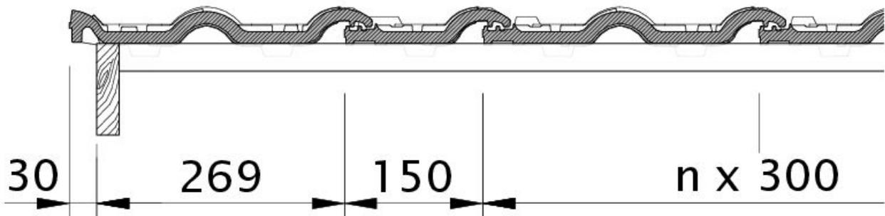
Disegno MAXIMA PRO gronda di frontespizio sinistra con lamiera laterale e doppia onda ODL
