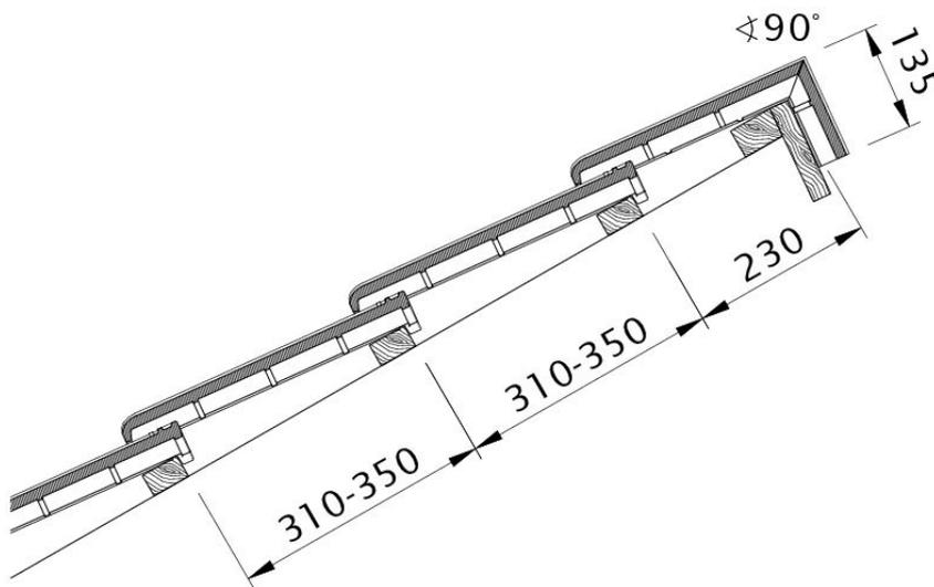
Disegno MAXIMA PRO modello di tetto a una falda PDA
