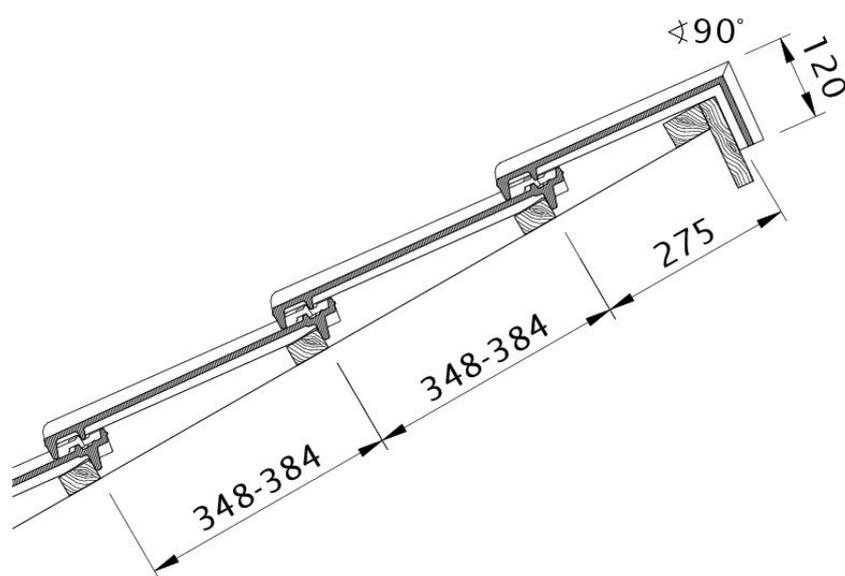
Disegno CANTUS modello di tetto a una falda PDA
